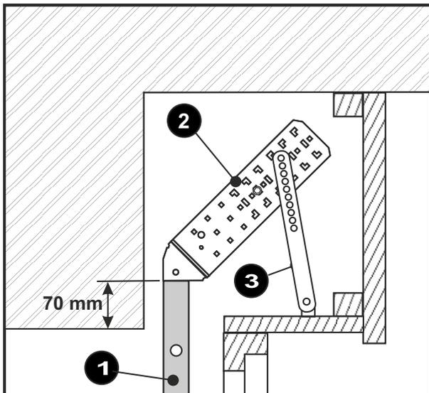
Ajuster les glissières (1), en les laissant dépasser de 70 mm au dessus de l'ouverture de la baie, et les fixer dans le mur.
