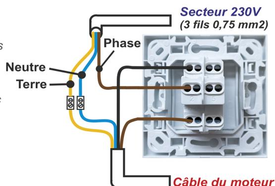
(\*) Si besoin, interchanger les fils noir et marron du câble moteur pour inverser les sens de manoeuvre.
