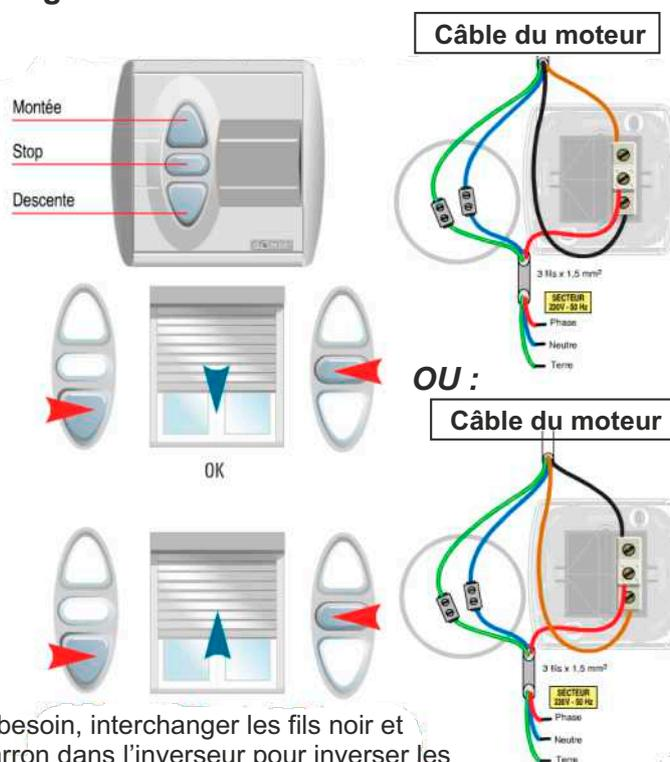
Si besoin, interchanger les fils noir et marron dans l'inverseur pour inverser les sens de manoeuvre.
