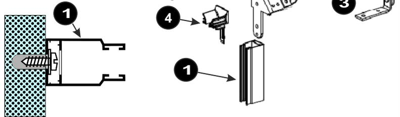
! Fixer les deux extrémités carrées du tube sur les supports (A), en enlevant tout d'abord les vis, puis resserrer celles-ci. Vérifier avec un niveau à bulle que le tube est bien horizontal.
