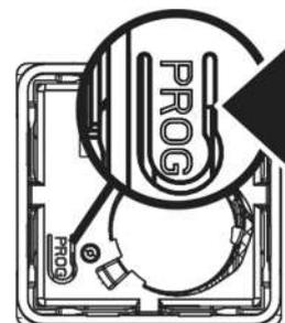
**REMISE À ZÉRO D'UN MOTEUR À COMMANDE RADIO**
