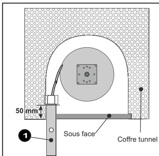
Ajuster la longueur des glissières (1), qui sont prévues pour dépasser de 50 mm au dessus de l'ouverture de la baie, et les fixer dans le mur.
