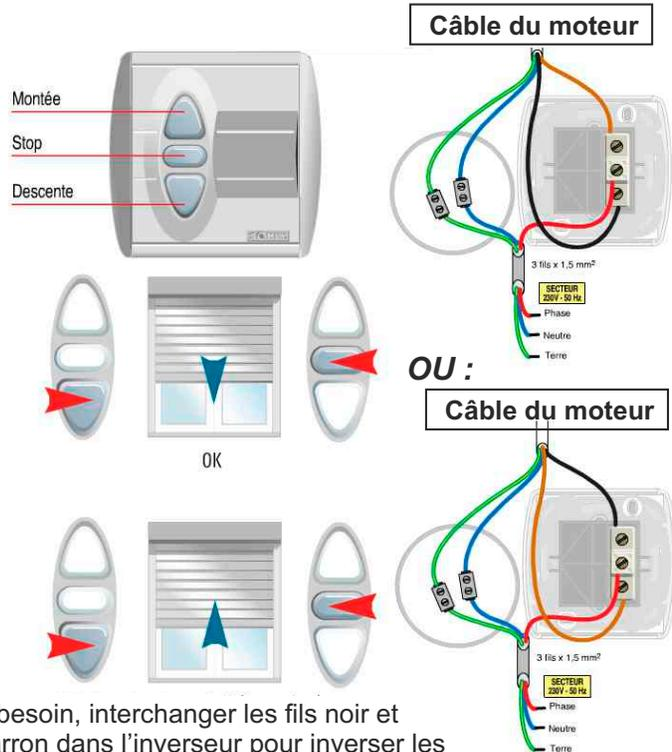
Si besoin, interchanger les fils noir et marron dans l'inverseur pour inverser les sens de manoeuvre.
