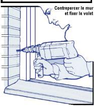
La serrure se trouve soit sur la lame finale (lame du bas), soit sur une lame intermédiaire. Il faut percer le fond des glissières à hauteur des tiges de serrure :
