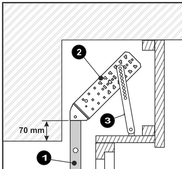
Ajuster les glissières (1), en les laissant dépasser de 70 mm au dessus de l'ouverture de la baie, et les fixer dans le mur.
