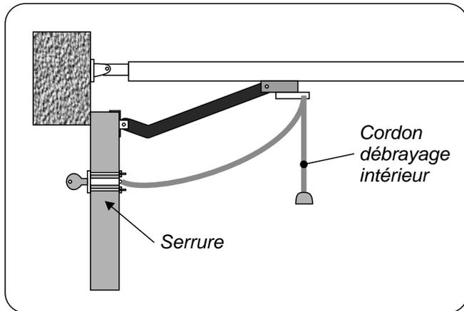
Insérer le canon de serrure dans les trous préperçés sur le panneau haut, puis le fixer avec les deux écrous et rondelles coté intérieur.
