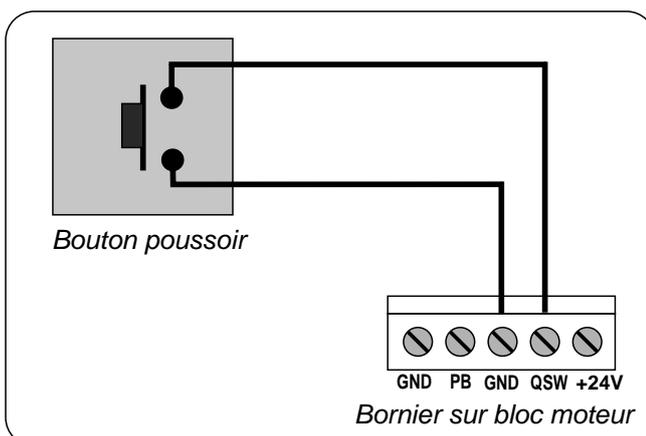
Déposer le capot translucide blanc du moteur pour accéder aux touches de programmation. Câbler le bouton poussoir avec les bornes marquées GND et QSW sur le bornier du bloc moteur (Câble 2 fils basse tension). Fixer le poussoir sur le mur, à un endroit tel que l'opérateur puisse visualiser et contrôler la porte de garage.
