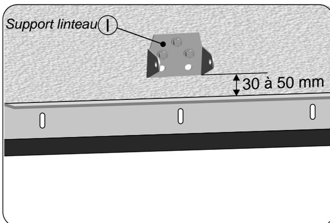
Fixer le support linteau **I** à une distance de 30 à 50 mm au dessus de la traverse haute, et au centre de la porte
