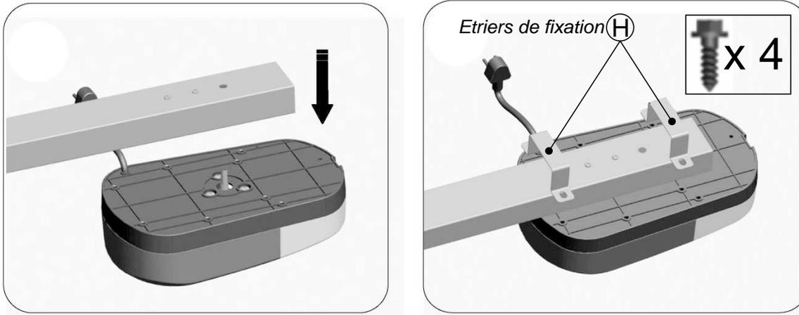
Présenter le rail moteur sur le bloc moteur, et engager l'axe d'entraînement du bloc moteur dans le pignon creux du rail moteur.
