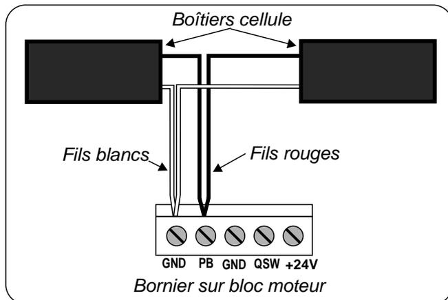
Dénuder à l'extrémité, puis torsader ensemble deux par deux les fils de deux boîtiers :
