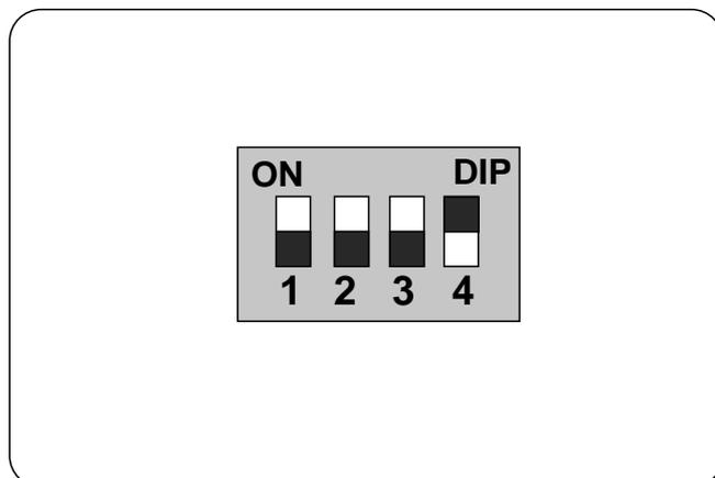
**IMPORTANT :** positionner le commutateur DIP n° 4 de la platine moteur sur ON ; le système de cellule photo est maintenant opérationnel :
