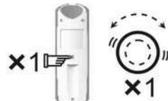
2) Appuyer 1 fois sur le bouton PROG en 10s, le moteur fait un va-et-vient
